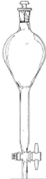
L'ampoule à décanter
